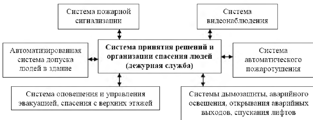
Рисунок 2 – Вариант построения комплексной системы безопасности в здании
